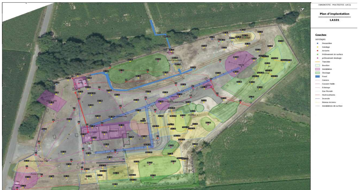
Plan d'implantation des sondages et des prélèvements sur le site de LA101
